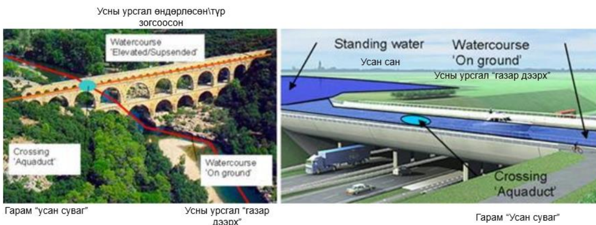
Е.10-р зураг – Хоорондоо огтлолцсон хоёр усны урсгал бүхий усан сангийн суваг (эх сурвалж: www.leestrainier.nl ) ба зам хөндлөн огтлолцсон усан сангийн суваг (усны түвшин газрын гадаргын түвшин хэвээр байна)
